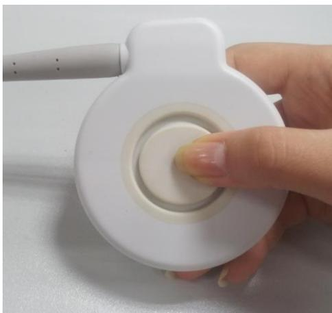
Рис. 7-7. Проверка токодатчика
