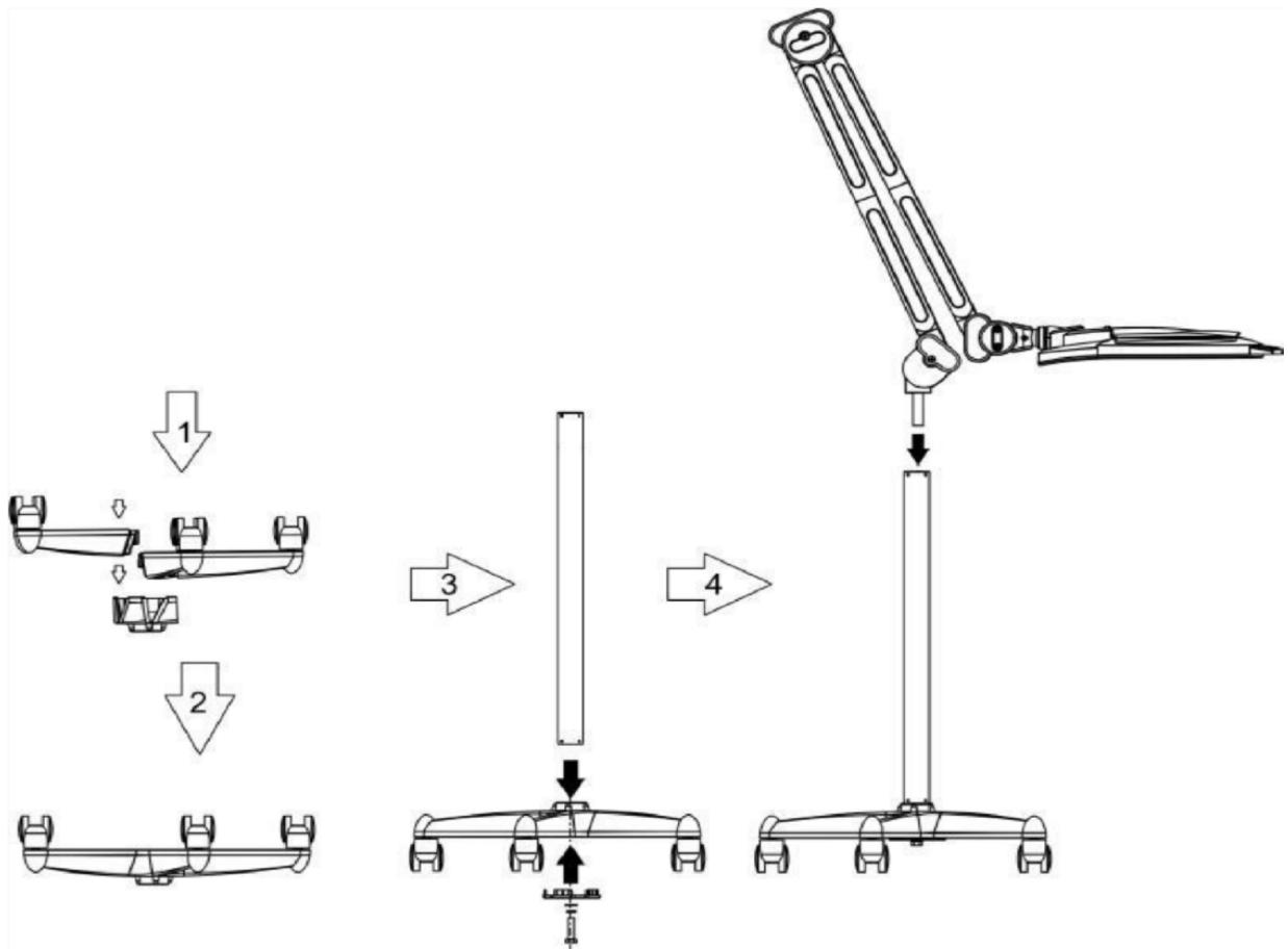
Рисунок 3 – Основные этапы сборки медицинского изделия (вариант крепления на стойке на колесиках)
