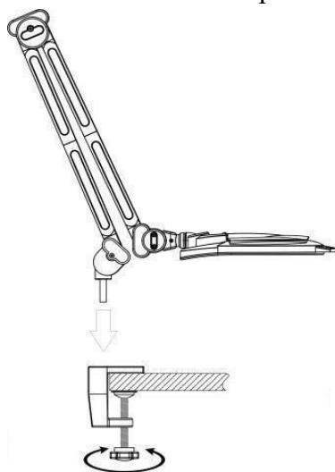
Рисунок 2 – Сборка медицинского изделия (вариант крепления на струбцине).
