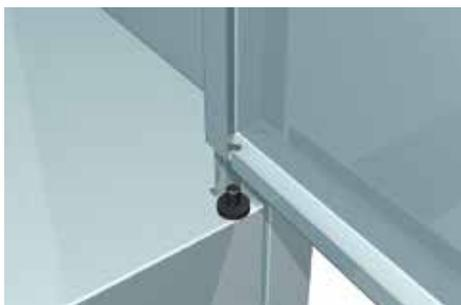
14. «Утопив» подпружиненный металлический наконечник верхней оси, завести дверь под верхнюю ось и совместить соответствующее отверстие в двери с осью до выщелкивания наконечника.
