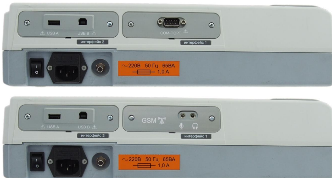
Рисунок 5.3 – Задняя панель ЭК с разными вариантами интерфейсов
