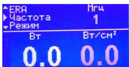
Навигация по меню (в левом верхнем углу) осуществляется кнопками **SELECT**, выбор нужных параметров ультразвука осуществляется кнопками **SET**, мощность ультразвука устанавливается кнопками **UP/DOWN**, предустановленные программы и программы пользователя устанавливаются кнопкой **PROG/MENU**
