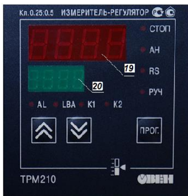
Рис.6. Лицевая панель измерителя-регулятора ТРМ210.
