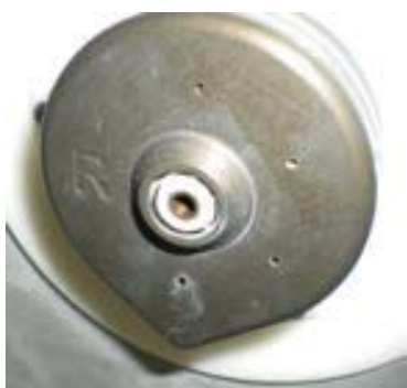
Колпачок шпинделя В - видимые винты отсутствуют
