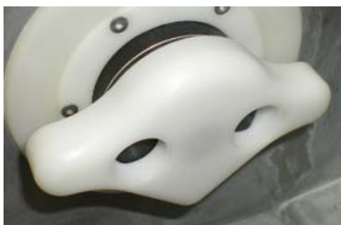
Инструмент колпачка шпинделя в запертом положении – 1 колпачок, направленный вниз
