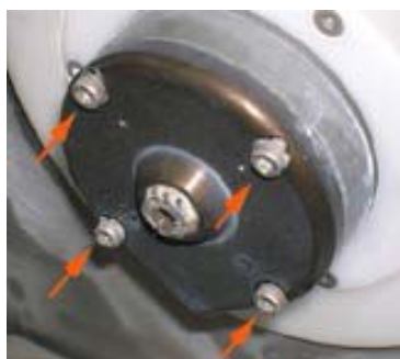
Колпачок шпинделя А – четыре видимых винта
