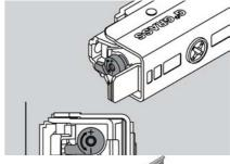
7.4 В процессе эксплуатации может потребоваться снятие выдвижного ящика. Для этого необходимо выдвинуть ящик на полную длину, а затем, нажав на фиксатор (1) между узкой и средней частями направляющих, вытянуть ящик на себя(2). Для обратного действия достаточно задвинуть ящик, фиксатор сработает автоматически.
