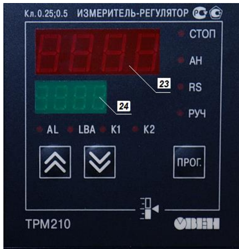
Рис.3. Лицевая панель измерителя-регулятора ТРМ210.
