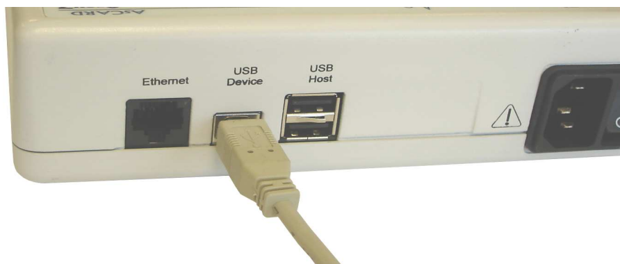
Рис.26. Подключение кабеля для связи с ПК
