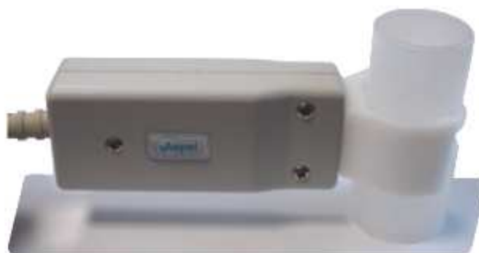
Рис.13. Позиция головки во время обнуления
