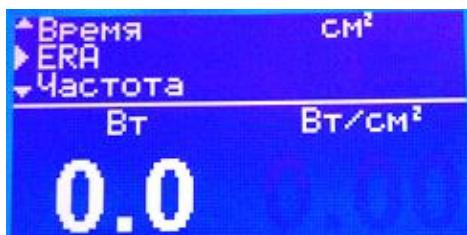
Навигация по меню (в левом верхнем углу) осуществляется кнопками **SELECT**, выбор нужных параметров ультразвука осуществляется кнопками **SET**, мощность ультразвука устанавливается кнопками **UP/DOWN**, предустановленные программы и программы пользователя устанавливаются кнопкой **PROG/MENU**
