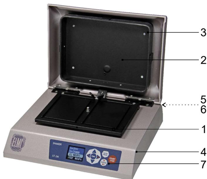
Шейкер-термостат состоит из нагреваемой платформы (1) и обогреваемой крышки (2) с уплотнителем (3), установленные на корпусе (4) с приводом вращения платформы. На задней стенке корпуса расположен сетевой выключатель(5) и разъем питания(6). На передней стенке корпуса расположена панель управления (7) с дисплеем и кнопками, имеющими следующие функции:
